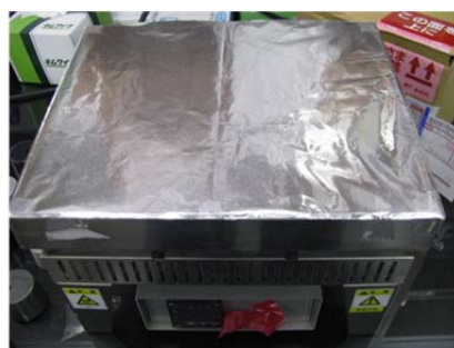
図2 サーモグラフィーによる放熱性確認方法
