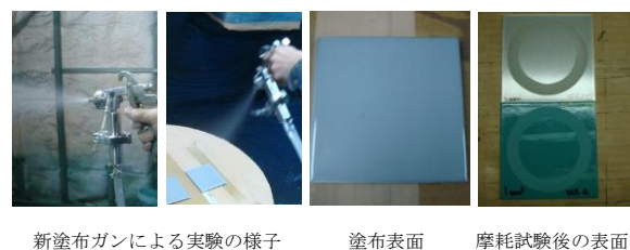
写真 2-2-1-2-2 新塗装ガンの塗布実験
