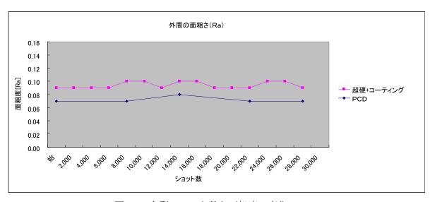
図 5.3 金型ショット数と面粗度の変化
