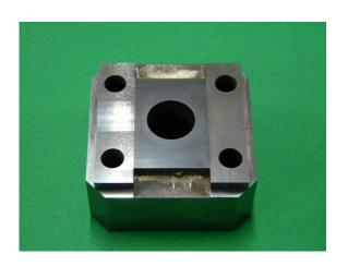
図 5.1 PCD 金型部品
