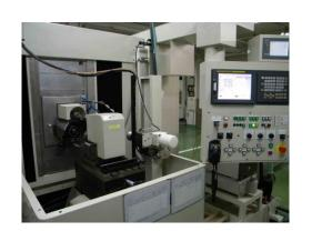
図 4.4 紫外光励起 PCD 研削盤
