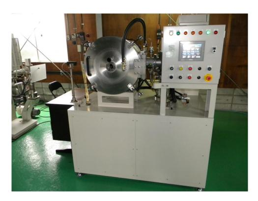
図 2.1 熱劣化レス PCD 接合装置
