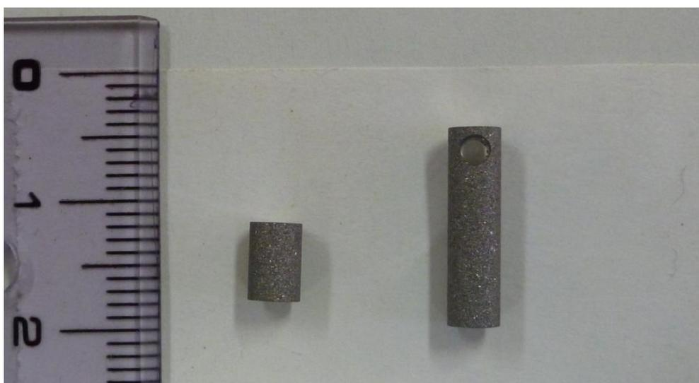
図 34 粗ブラスト棒材から切り出した生体試験片
