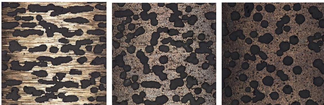
図 11 表面粗さの変化による多孔質組織の変化(左から、ブラスト処理無し、2min、4min)
