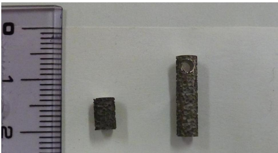
図 33 多孔質棒材から切り出した生体試験片(左:骨誘導試験用 右:引抜き試験用)
