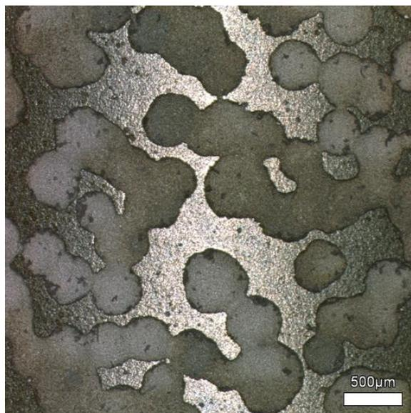
图 24 2%NaCl 水溶液中 12.5V 20 分間
