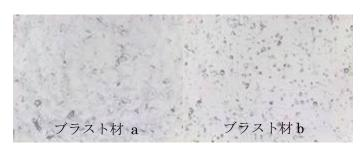
図 2-2. ブラスト材 a と b を用いた試作品の表面。
