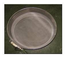
図 2-7. 試験用ふるい 開口 75µm メッシュ。
