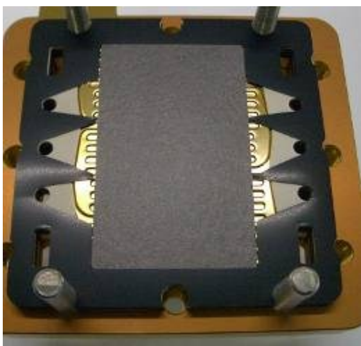
図 5.7 冷却用カーボンペーパー(旧タイプ図)
