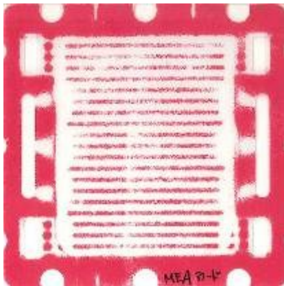
図 5.3 接触面の面圧テスト結果(単セル)
