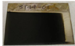
図2-1a ST144配合浴でのハルセル試験 (5A×5分) とその膜厚測定結果
