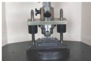
図1-2 曲げ試験装置
