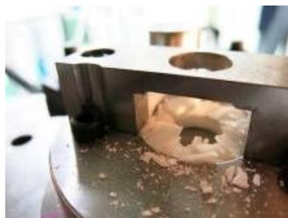
図7 - 7 圧縮破壊試験後のセラミックダイス
