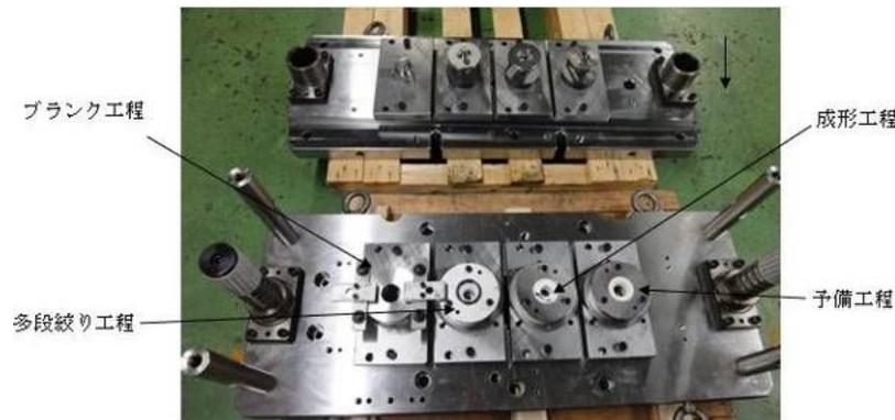
図6 - 1 実験用試作金型
