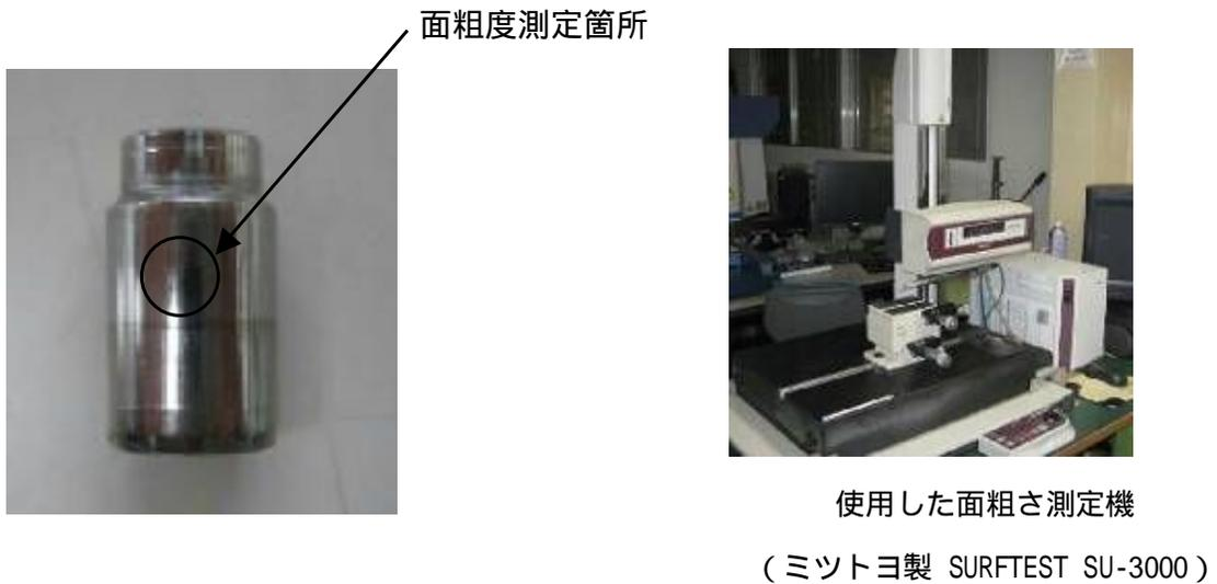
図8 - 8 製品の表面粗さ測定箇所と使用した表面粗さ測定機
