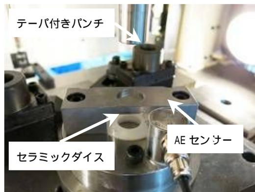
図7-2 圧縮破壊試験の概観
