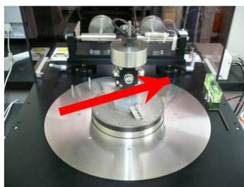
図 1 - 1 1 ボールオンディスク摩擦試験状況
