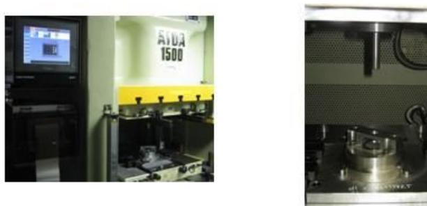
図6-3 トライプレスと多段成形金型
