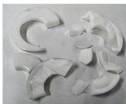
図6-4 破損したセラミックダイス
