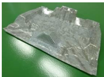
図.3 バッテリーアンダーカバーの成形例
