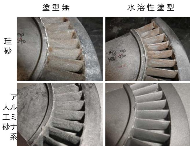
図 2-2-3 ステータの試作例
