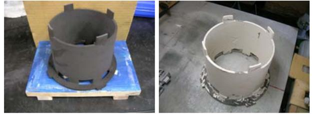
図 2-2-7 造型したまま 塗型塗布後、乾燥砂中子外観
