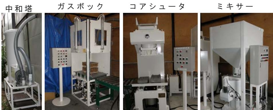
図 2-3-1 砂中子造型装置
