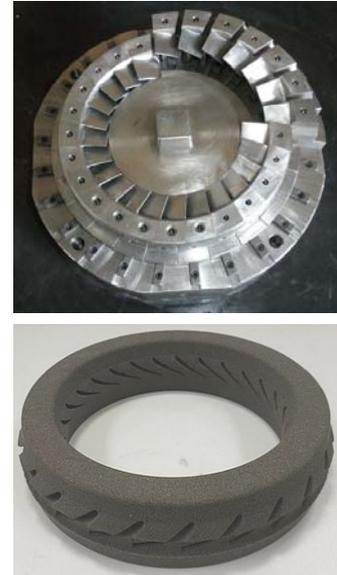
図 2-3-3 ステータ用砂中子型(上)と砂中子(下)
