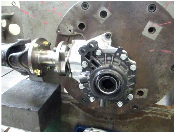
図 40 動力試験機にセットしたトランスファー
