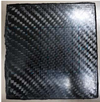
図 24 平板から短冊状に試験片を切り出し試験片を製作
