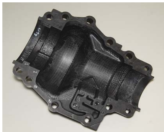
図 7 連続繊維の骨格で補強した複合成形品
