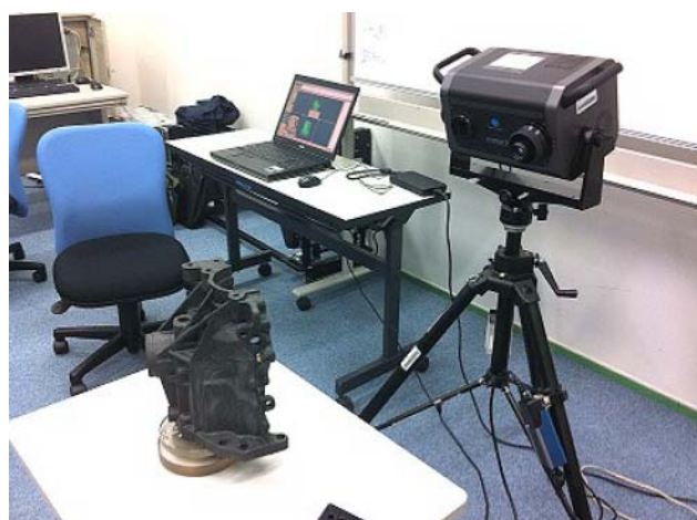
図 14 非接触 3 次元デジタイザを使った計測
