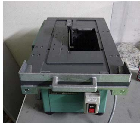
図 24 平板から短冊状に試験片を切り出し試験片を製作
