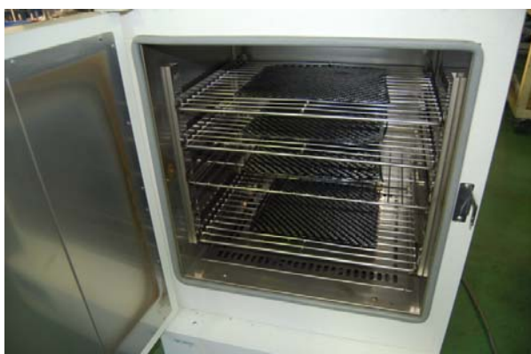
図 21 熱風乾燥機でエポキシ樹脂を重合
