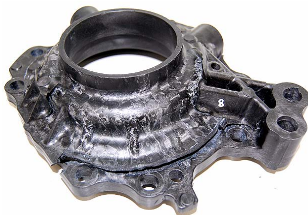
図 43 破壊したサイドカバーの表側
