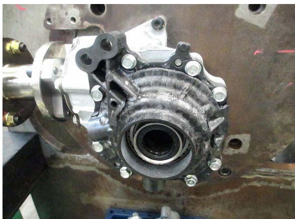
図 42 2200N・m で破壊したサイドカバー
