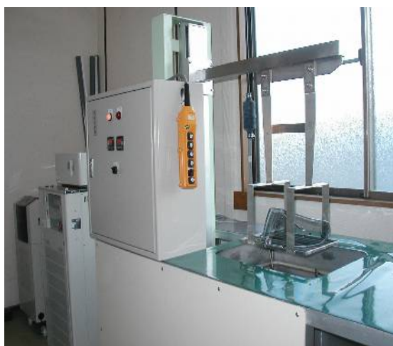
図 4-1 ディップ法成膜装置
