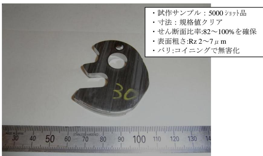
図 5-3 開発した自動車用シートフレーム機構部品
