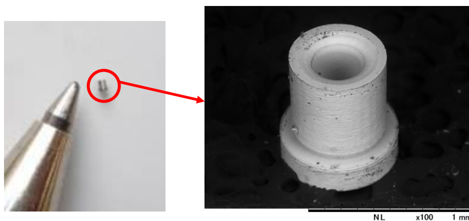
图 1-4-1 微小電鑄金型の例
