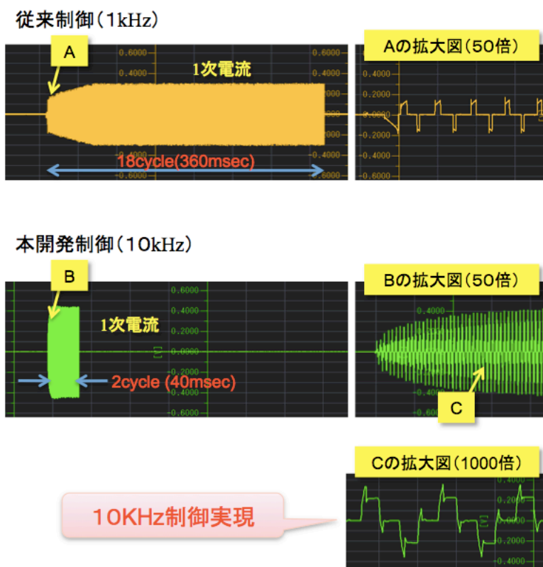
図6 従来制御（1kHz）高精度制御（10kHz）比較
