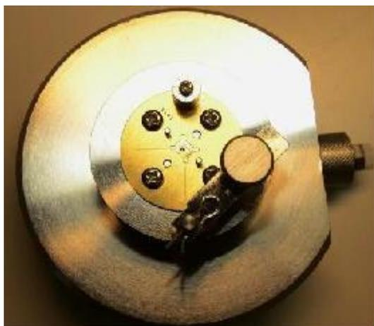
図 3-4 1612 型水晶振動子用測定治具
