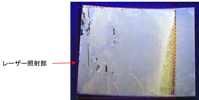
図 2-2-3 厚膜有機膜へのレーザー照射
