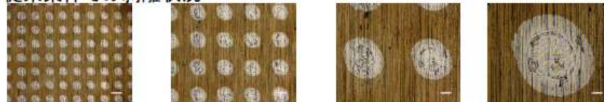
図 2-3-10 効率化条件での炭素薄膜剥離状況の観察結果（基材：インバー合金基板）
