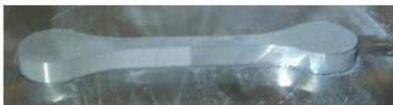
左右で異なる鉄粉を有する引張試験片
