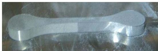
左右で異なる鉄粉を有する試験片（圧粉体）
