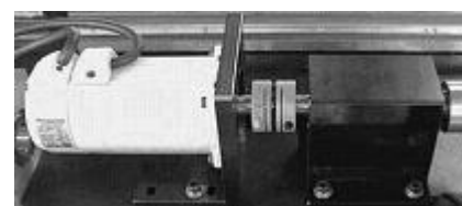
サーボモータとボールネジを つないでいる 軸継手の例
