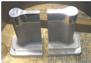
左右分割された引張試験片用金型
