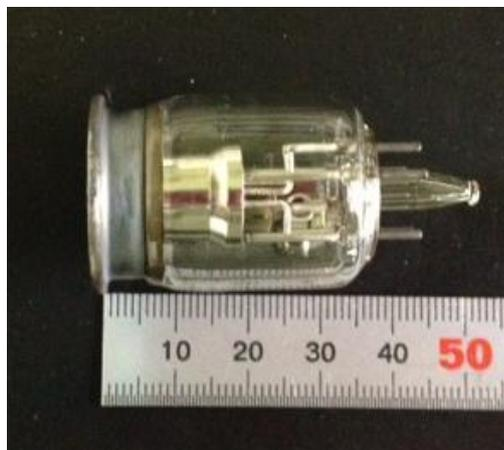
図 2-5-2 【3】 試作 NanoX 線管模式図
