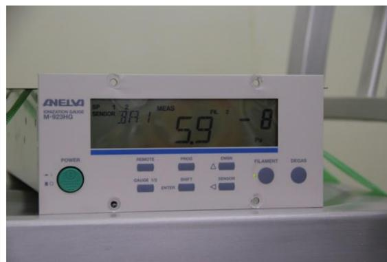
図 2-1 【7】 真空排気後の真空度
