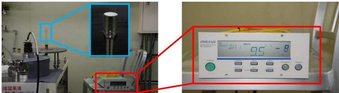
図 2-3 【5】 硝子-Si 陽極接合真空排気テスト。左図差し込み図は陽極接合真空容器
