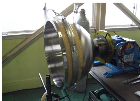
図 2-15 ドーム部材、帯板及びフランジの試作溶接施工における治具取付状況
