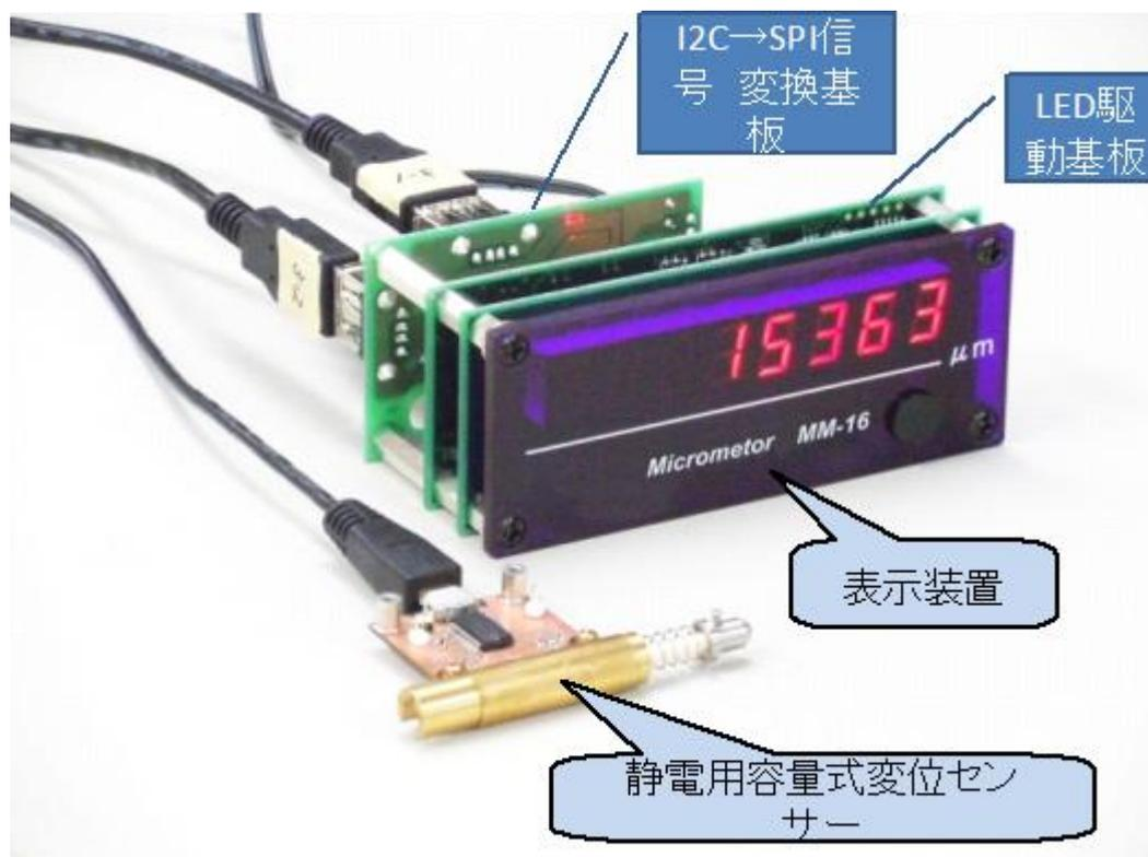
図 2-2.2 PSoC を用いたセンサシステムの全体図
