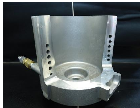
駆動モーター用ジャケット模擬品 内部切斷写真
