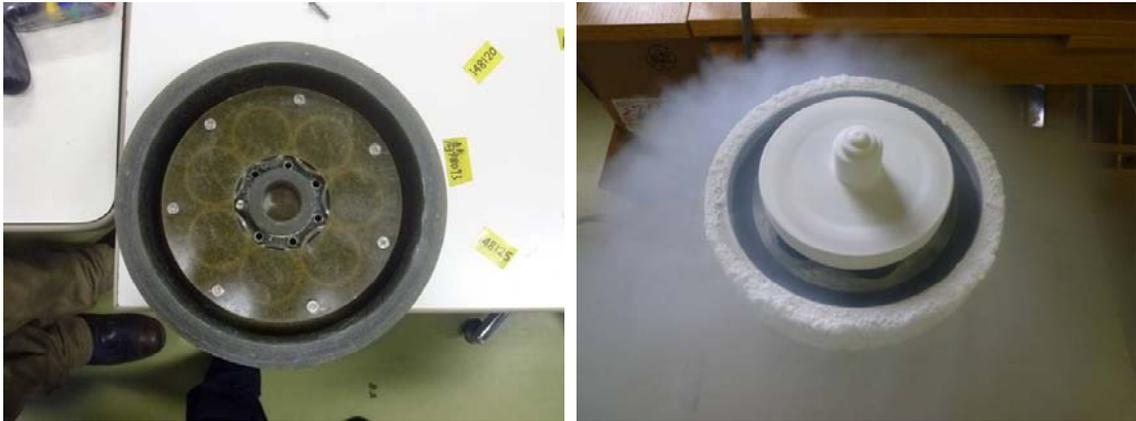
図 2-5-1 ポンプ用回転機器にて高速回転するバルク体
