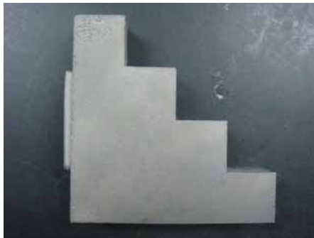
図 5-12 鋳物（樹脂燃焼による脱樹脂）
