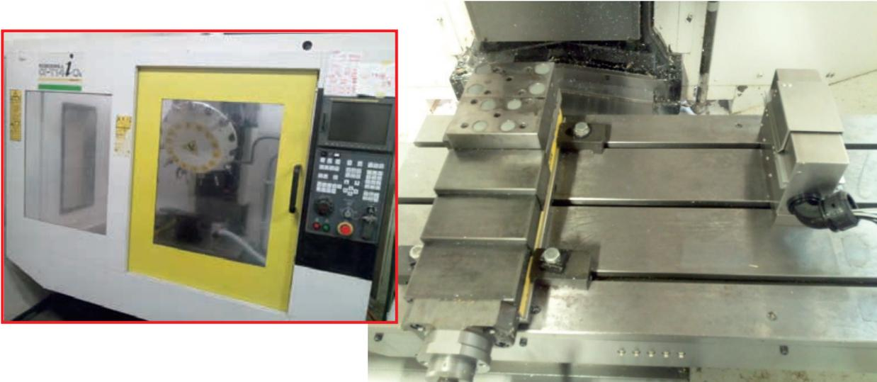
図 2-22 3軸制御マシニングセンタ(FANUC Robodrill)内の DynaVision 設置例
