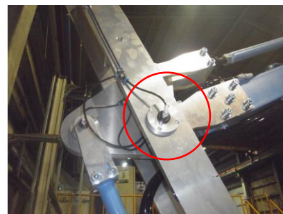
図 14 防塵カバーの取付け、関節部へのエアージェット
