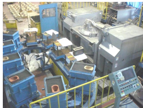
図 2 左：薄肉化耐熱鋳鋼鋳造装置イメージ図、右：装置全体
