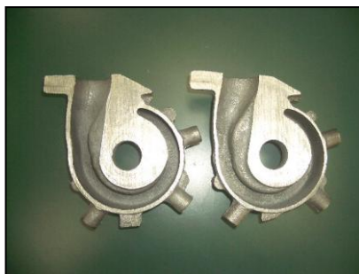
図 27 左：薄肉化前の製品、右：薄肉化製品
