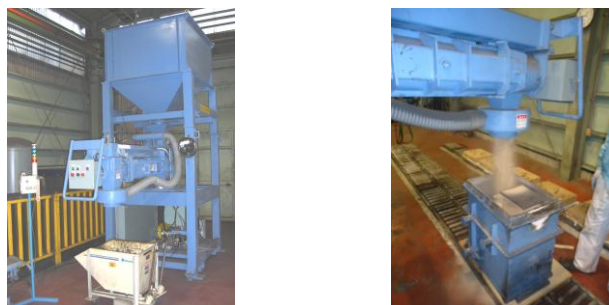
図 17 鑄型バックアップ砂充填装置
