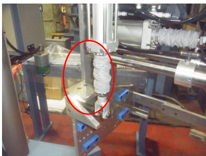
図 14 防塵カバーの取付け、関節部へのエアージェット
