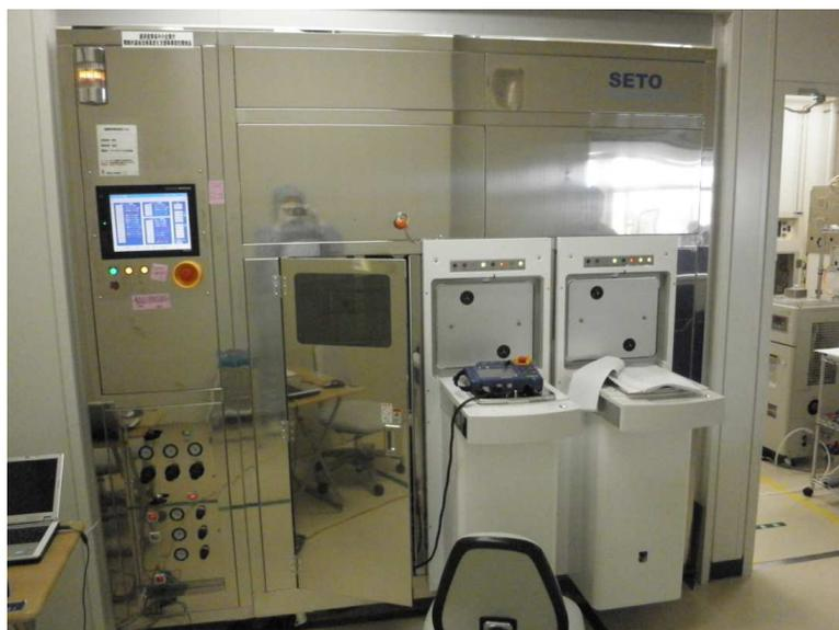
図 6-33 洗浄装置（全体）【瀬戸技研工業株式会社製】
