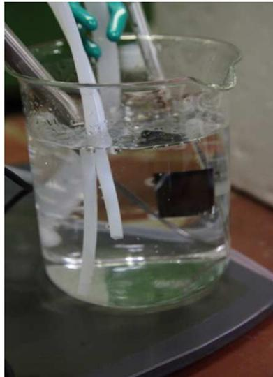
図 2-13 ウエハサンプルの浸漬状況
