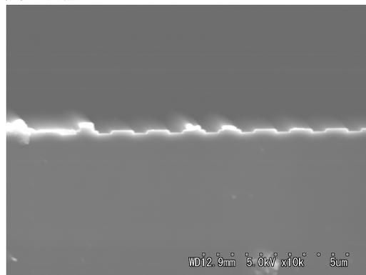
図 6-12 ポリ Si エッチング試料（エッチング時間：30 秒）の洗浄試験結果（TMAH 濃度：0.5%，洗浄時間：10 分）
