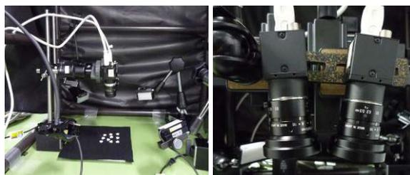
図2-2-18 錠剤照合システム（左：全体、右：ステレオカメラ部分拡大）
