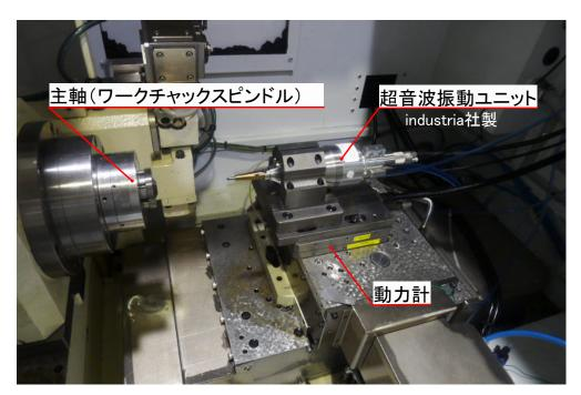
図 2.1.23 超音波加工専用実験装置
