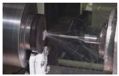
図 2.2.22 シート面の超音波電解研削
