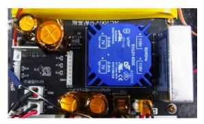
ロードセル入力電圧生成回路
