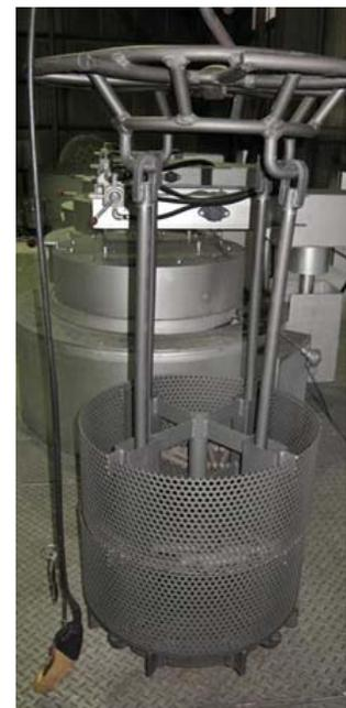
図 12 熱処理バケットによる熱処理品セット状況
