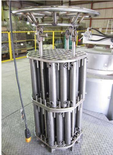
図9 改良型熱処理治具製品セット状況
