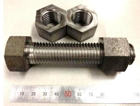
図 5 熱処理後に加工した M20 六角ボルト・ナット外観
