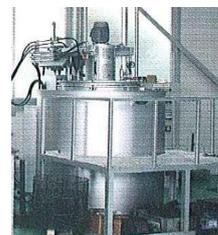
層内に充填されたアルミナ粒子が、下からの流入ガスにより流動層化して液体に似た振舞いをする。
