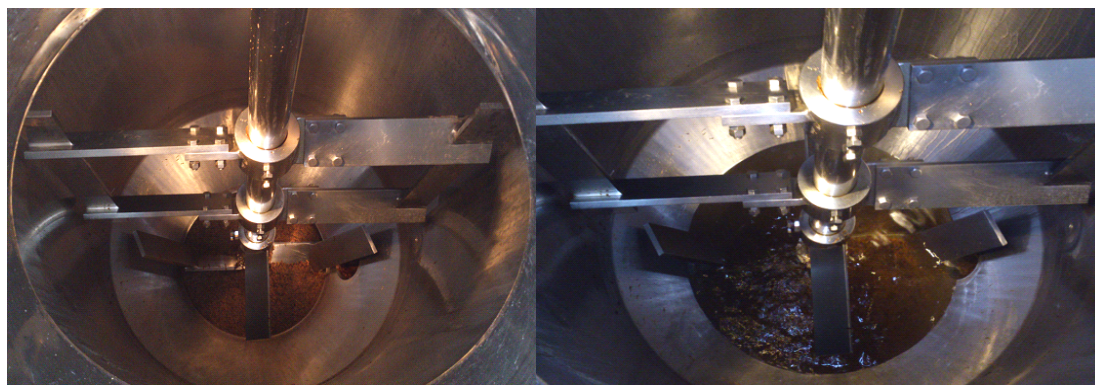
写真9 釜内に仕込んだ菌体残渣（右）とエタノール（左）
