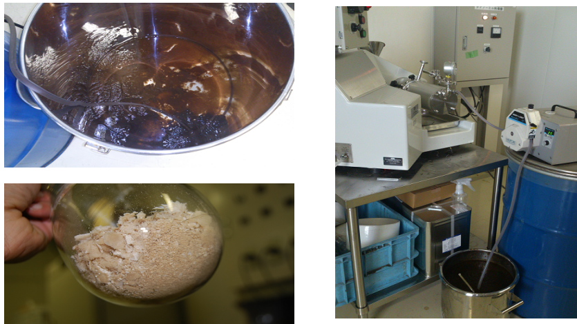
写真3 粉碎されたグルカン（左上）、フリーズドライしたグルカン（左下） ダイノームル装置（右）
