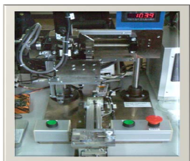
Fig2-5-3 手動組立装置 左：組立・荷重測定ユニット 中：動作確認ユニット 右：回転角確認ユニット
