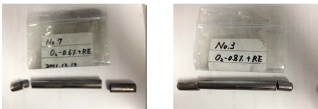
Fig2-2-1-1 破損した材料 左図：0.6%RE 右図：0.8%RE
