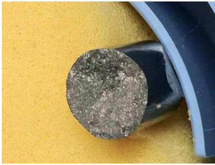
Fig2-2-1-3 破損した材料
