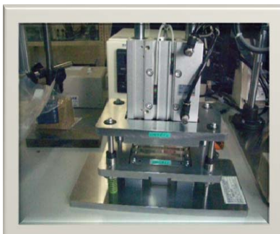
Fig2-5-3 手動組立装置 左：組立・荷重測定ユニット 中：動作確認ユニット 右：回転角確認ユニット
