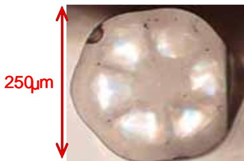
図 2 パワーコンバイナ断面写真
