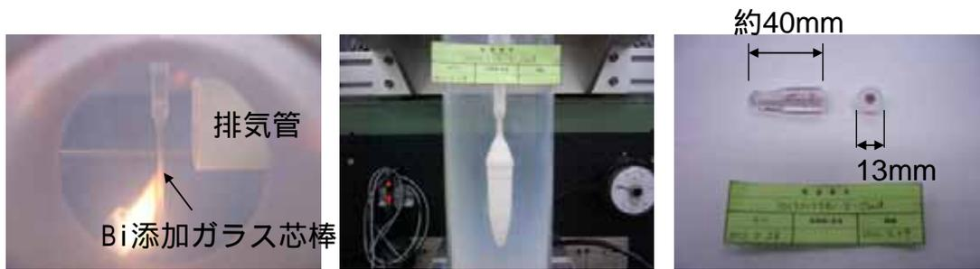
a)外付け法      b) 外付けクラッドコート      c) Bi 添加ガラス母材
