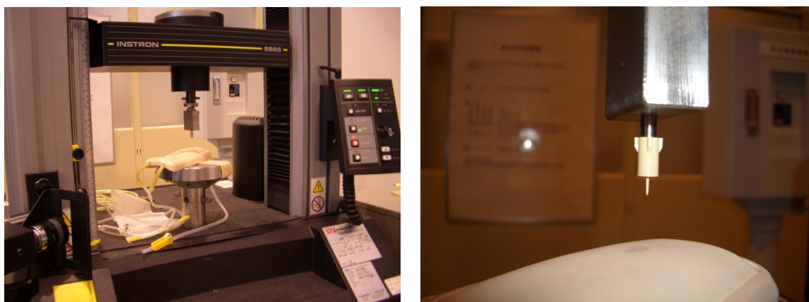
図 4-1 穿孔荷重測定試験の様子
