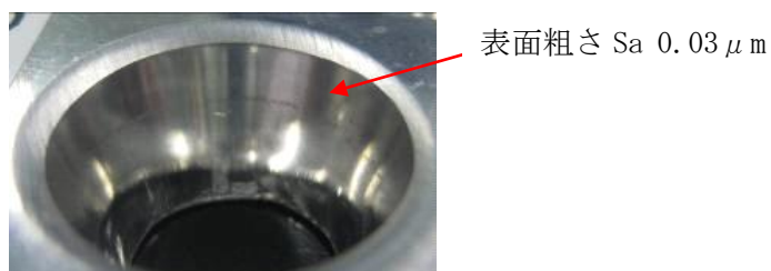
図 18 マルチリフレクタのプレス成形鏡面
