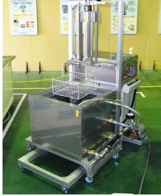
図 14 独自脱気装置を備えた超音波洗浄装置
