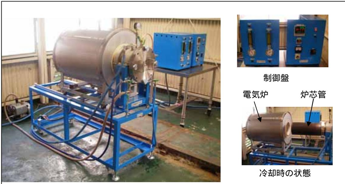
写真 3-3-2-1 炭化焼成炉
