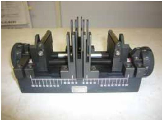
図 5-2-0-2 ENF 試験用 3 点曲げ試験治具
