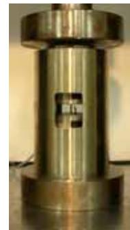
図 5-2-0-3 圧縮試験用治具
