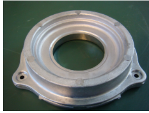
試験用金型成形品 可動側
