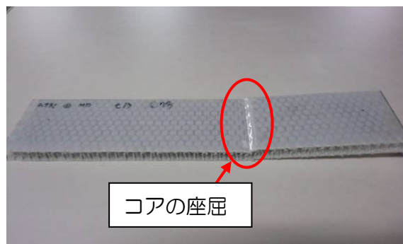
図 5-3 0.7mm ラミ製品曲げ試験後
