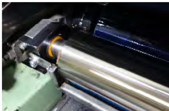
Photo. 15 クロムローラ取付テスト状況
