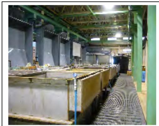
Photo.3 実証試験用多元系無電解ニッケルめっき設備
