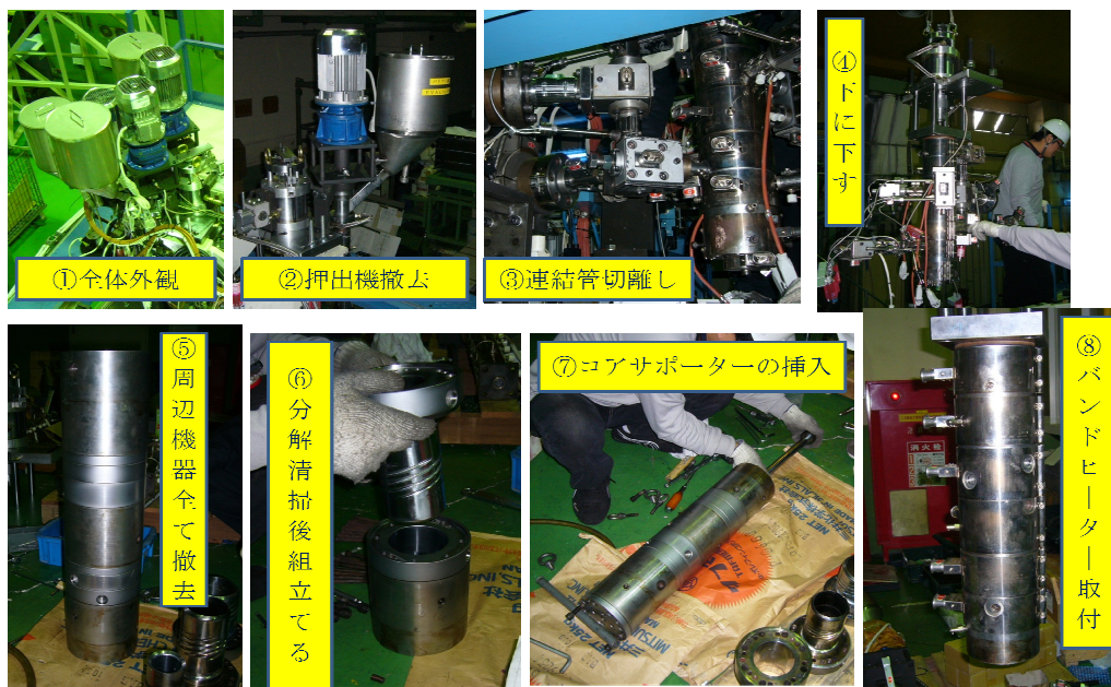
図2-14 ダイヘッドの分解、清掃作業
