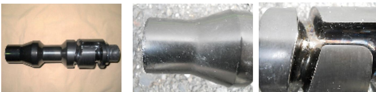
図4-4 硬質クロムメッキのダイヤモンドレル
