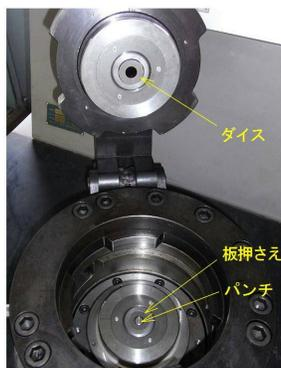
図6-4 偏心打抜実験用金型の全景
