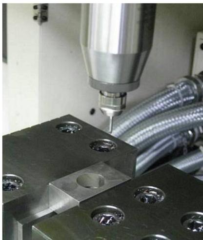
図5-5 高速スピンドル加工風景
