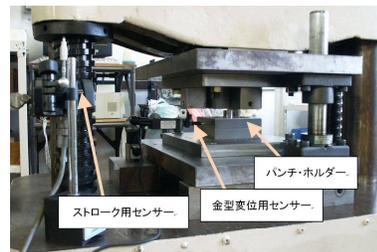
図 6 - 1 3 ストロークと金型変位計測用のセンサー取付部
