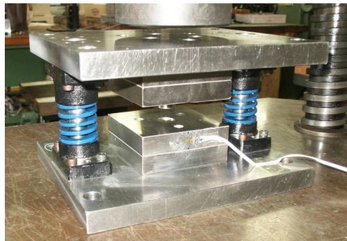
図 8 - 2 ボルトレス金型外観
