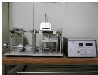
図 2 - 1 スガ式摩耗試験機
