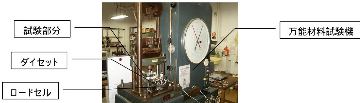
図1-2 試験装置(100 KN 万能材料試験機および試験部分)
