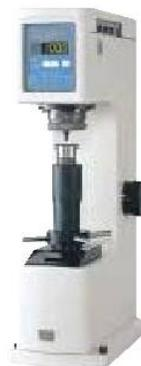
図 6 - 2 0 ロックウェル硬さ試験機
