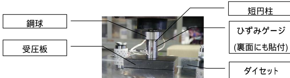
図1-8 球を介して試験荷重を加えた短円柱の圧縮試験
