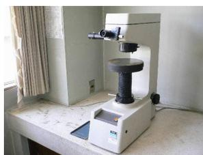
図3-2 ビッカース硬さ試験機
