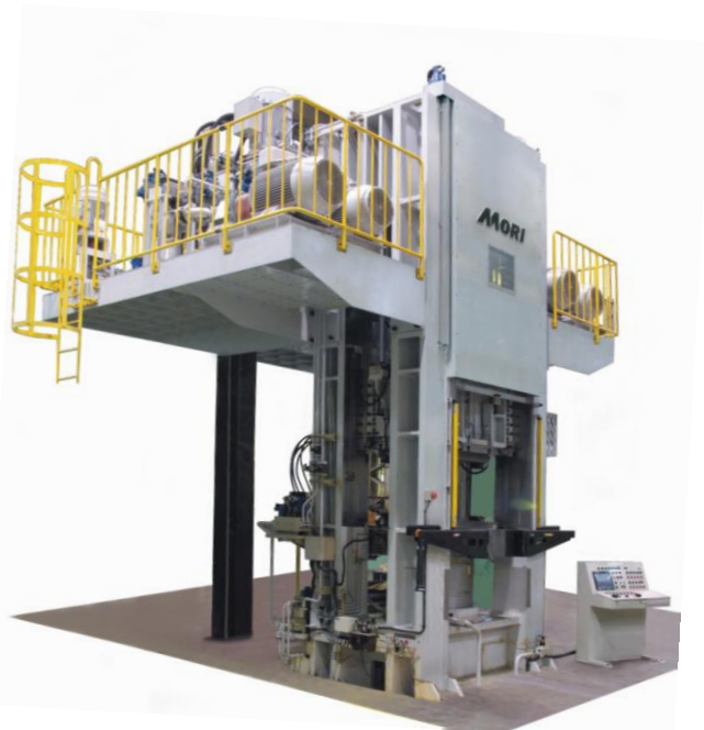
写真 2-1 6 軸サーボ制御 10,000kN 試験機の概観
