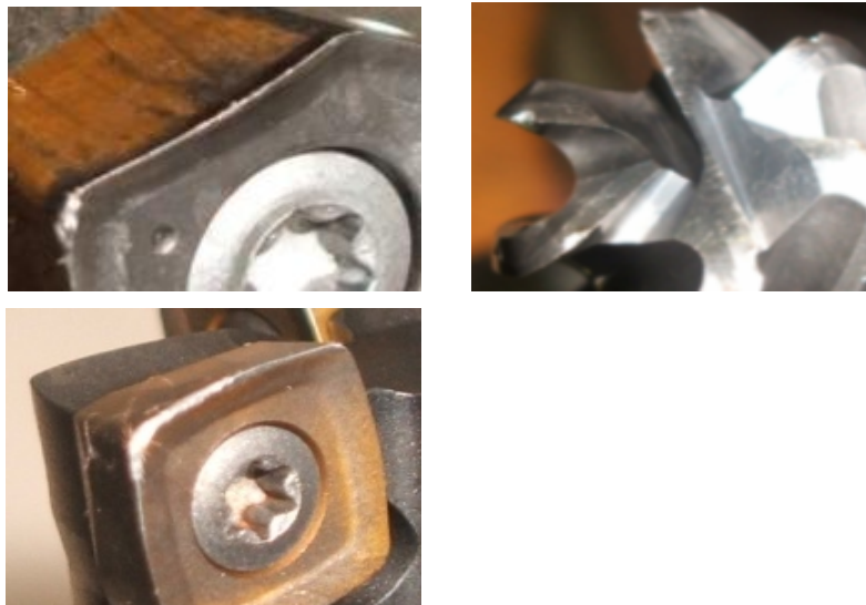
図3-2 チタン用市販工具の形状別工具摩耗状況
