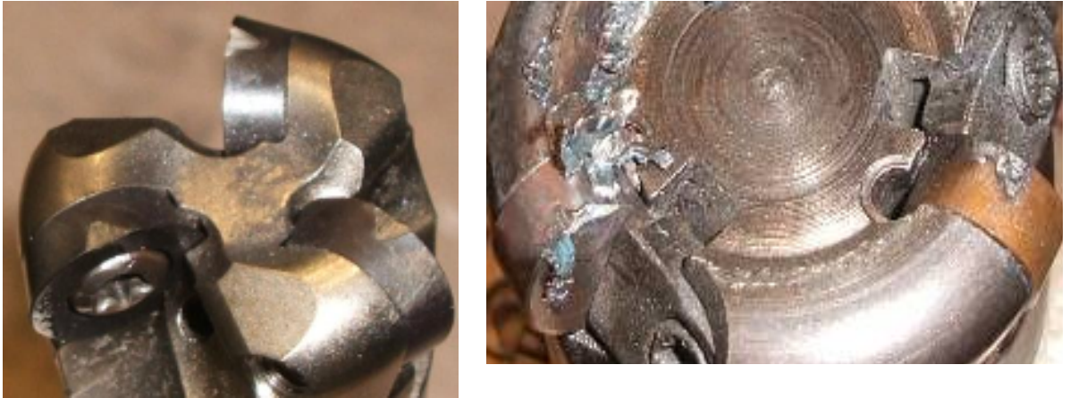
図3-1 インバー用市販工具の形状別工具摩耗状況
