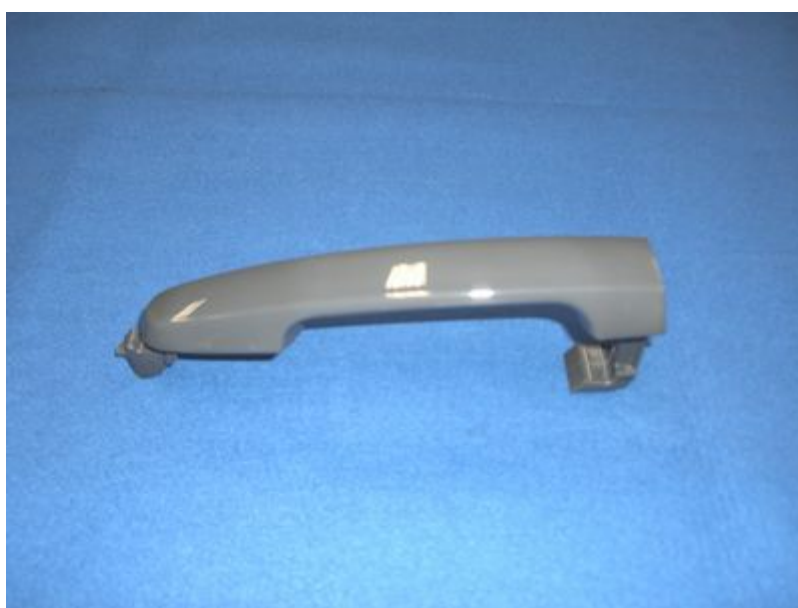
図 9-2 成形テスト⑩ (金型温度 160°C⇔80°C)
