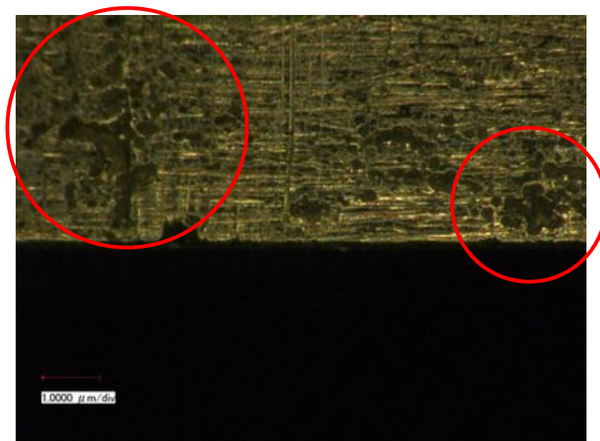
図 3-5 20万ショット時の金型表面の状態 (比較参考)
