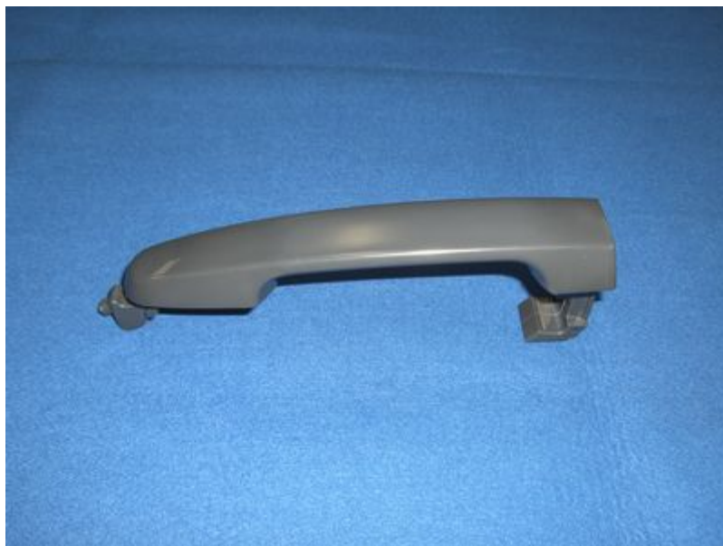
図 9-2 成形テスト⑦ (金型温度 100°C⇔80°C)
