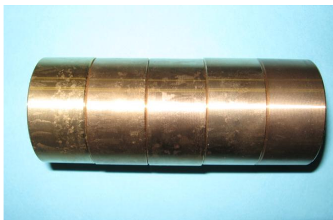
図 3-2 開発した CAC900 系鉛フリー銅合金標準物質
