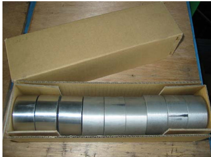
図 3-1 開発したアルミニウム合金標準物質
