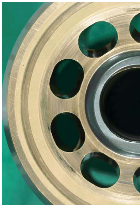
図 開発合金によりバイメタル化したピストンポンプ
