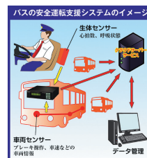
安全運転支援システム
