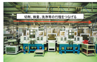
自動搬送システムを搭載して複数の加工行程を連結
