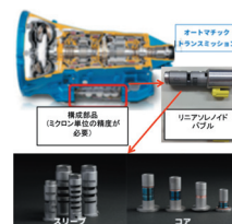
オートマチックトランスミッションと搭載されている当社製品
