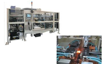
NC 電鍛機と電鍛加工の様子
