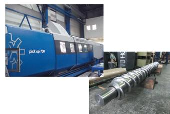
国内随一のワーリング方式大型スクリュー加工機
